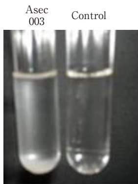
図9 分泌型炭酸カルシウム耐性微生物Asec003の尿素—カルシウム培地での沈殿生成 (1.5M Urea, 0.5M CaCl 2 を含む0.1×LB液体培地)
