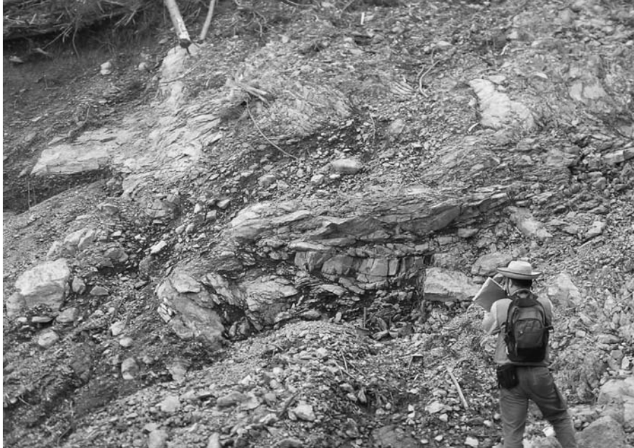
写真7 加州地区の崩壊地内部（側壁）に見られる岩盤クリープによる変形構造（西山賢一撮影）
