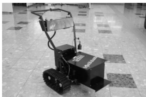
図 4 試作モータを取付けた小型電動車両 試作 1 号機
