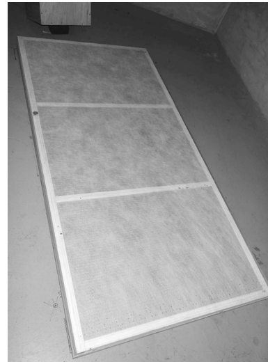
図5 残響室の床に設置した試作パネル
