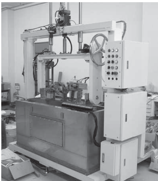
図2 実験装置(水没式リークテスター)
