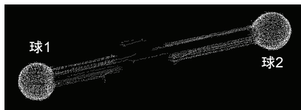
図 6 球間距離測定用標準器の立体形状モデル
