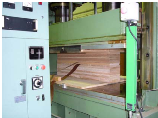
図1 直線型による高周波加熱成型加工
