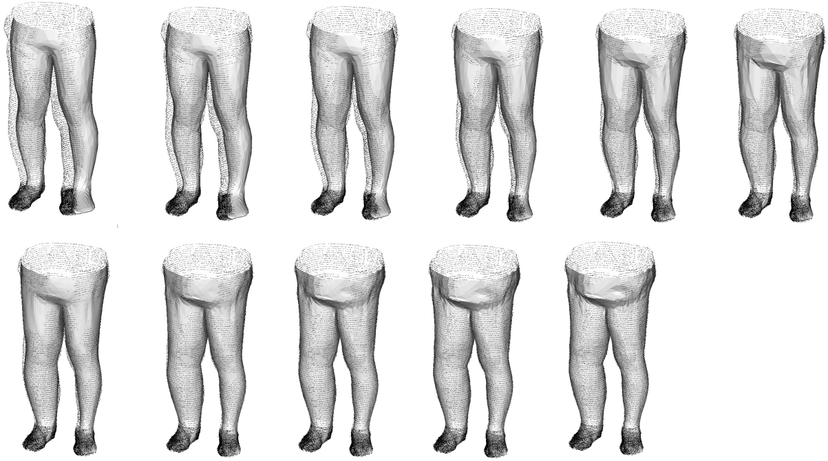
図7 フィッティングの様子. 左上から, 処理前の一般形状, 手順 1, 2, ..., 10 を処理後の再構築モデル. 累積計算時間は, 手順 1 (2.6s), 手順 2 (3.5s), 手順 3 (4.2s), 手順 4 (5.0s) 手順 5 (5.7s), 手順 6 (12s), 手順 7 (35s), 手順 8 (43s), 手順 9 (52s), 手順 10 (65s).
