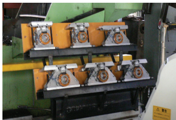
図 12 簡易架台と 6 種の箱詰め用ハンド
