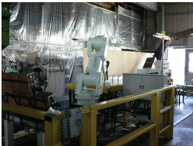
図9 新しく開発したねじの箱詰めシステムの全景
