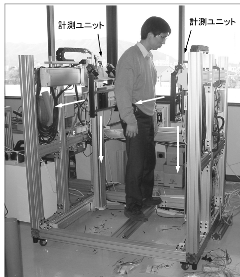
図7 非接触断面形状計測装置の外観
