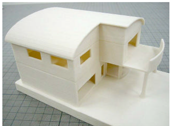
図 11 粉末造形機で製作した建築模型
