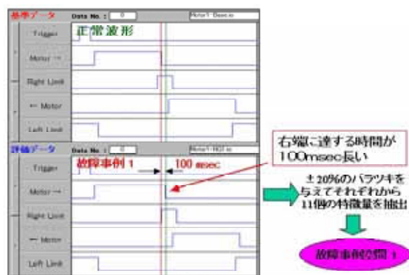
図10 故障事例空間1の作成方法
