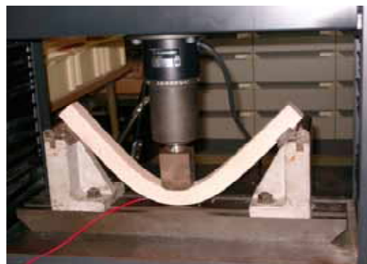
図5 圧縮処理材の曲げ試験（ブナ材）
