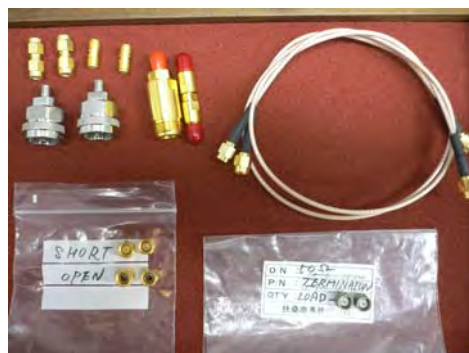
写真4. SMA 用治具一式
