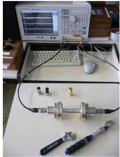
写真5. SMA 用治具一式
