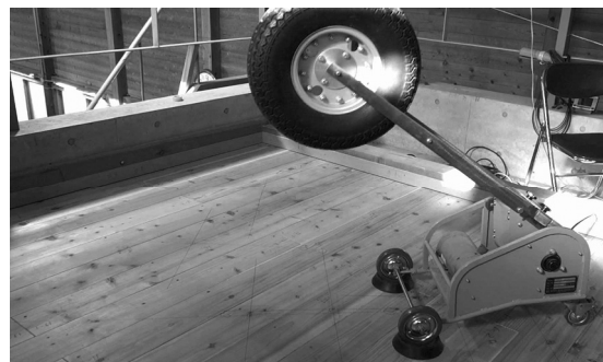
図1. 重量床衝撃音レベル低減量の測定の様子
