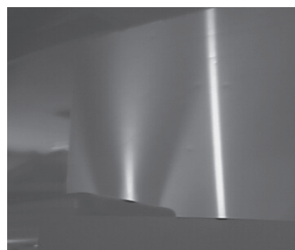
図2 LED赤外線光源（左）とハロゲン光源（右）の出射口付近の撮影画像（950nm～1300nm）
