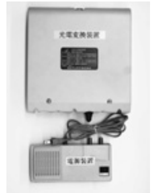
交換する光電変換装置と電源装置
