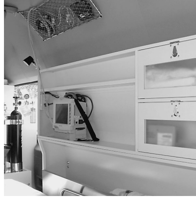
▲自動血圧計や担架、ライトなど救急に必要な器材を収納できる大棚です。
