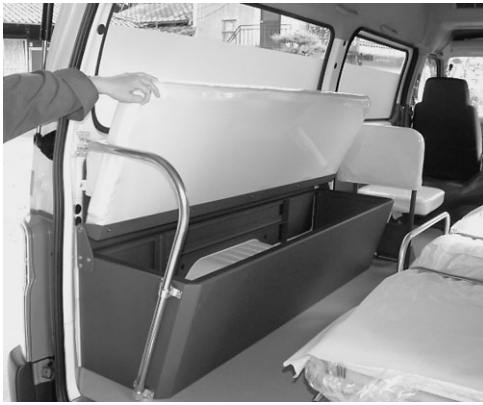
▲座席ベンチの下にも収納できるスペースがあります。ここでは、布製の担架などの道具が入ります。
