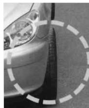
高速で回転する突出したタイヤやホイールは、歩行者に危害を及ぼしやすく、車体やブレーキ機構への干渉により事故や故障の原因にもなります。
