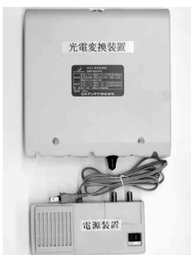
交換する光電変換装置と電源装置
