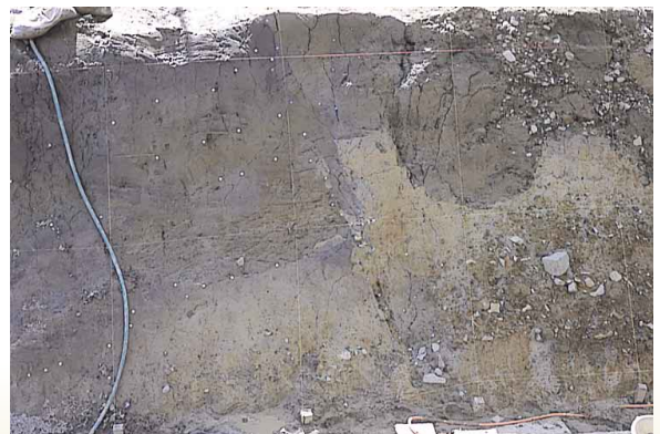
図3 板野町川端のトレンチ調査で見つかった断層(1999年8月9日撮影)
